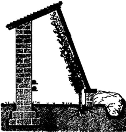
Fig. 23. — Serre à pêchers pour 1<sup>re</sup> saison, chauffée au thermosiphon.
