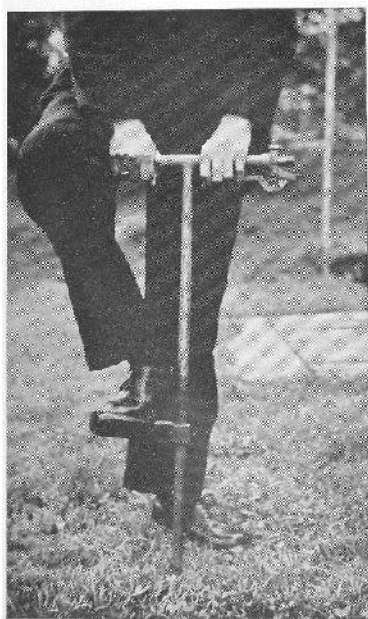
Lans voor het inspuiten van meststoffen : systeem Birchmeier.
