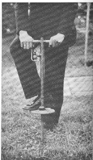
Een tweede soort lans voor het inspuiten van meststoffen : systeem Wetstein.
